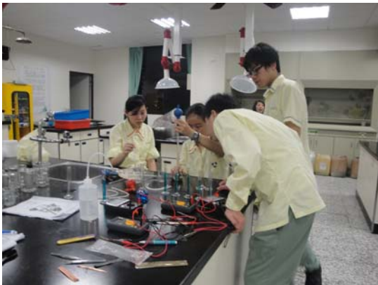
圖 3.15 自製實驗-鋅銅電池
