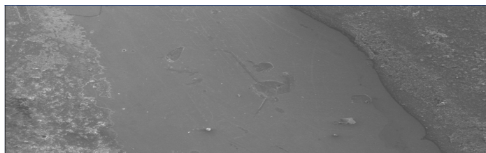
圖 9 浸泡於 1M 醋酸中 4 小時試片放大 35 倍之 SEM 照片。
