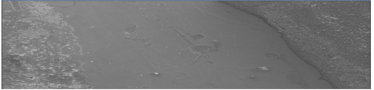
圖 10 浸泡於 1M 醋酸中 4 小時試片放大 35 倍之 SEM 照片。
