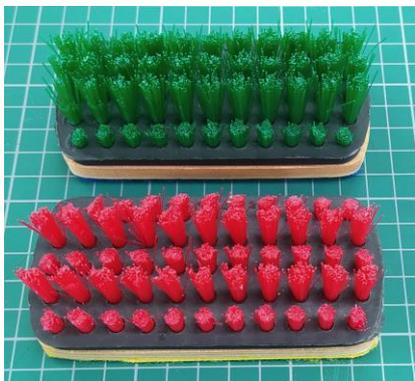
圖9 「修剪第1、5排保留第2、3、4排的刷子」和「修剪第1、3、5排保留第2、4排的刷子」(由上至下)
