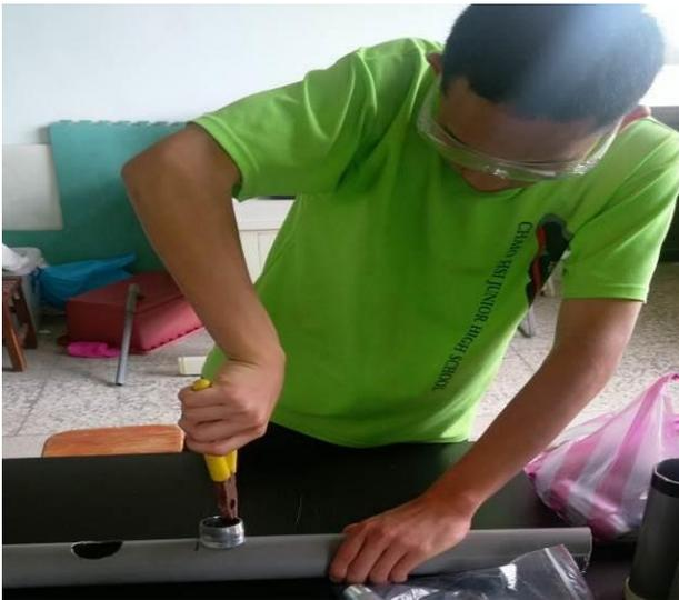
說明：水管鑽孔(火槍烙孔)
