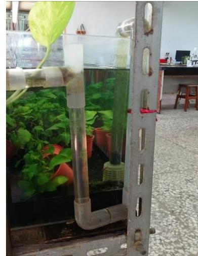
說明: 自行研發免開孔底部過濾加裝套件
