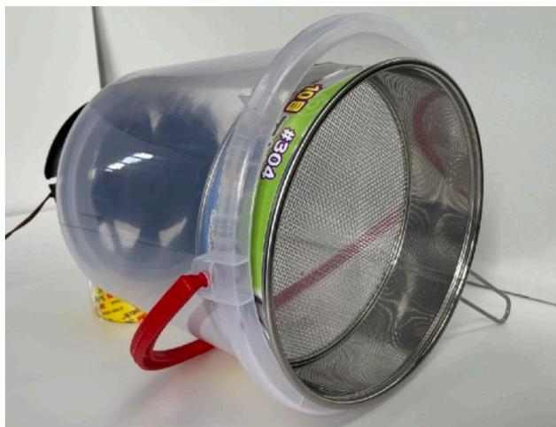
半透明的塑膠水桶，底部挖出圓孔，安裝送風機，並在桶口處尋找合適大小的麵粉濾網，最後在濾網圓孔處加上大小管，作為穩定風場的功能
