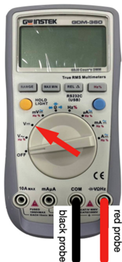
圖 P-3：顯示本次測量中使用的萬用電表以及探針位置和檔位選擇。
