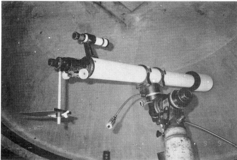
照片五 折射式望遠鏡，口徑 80 mm。
