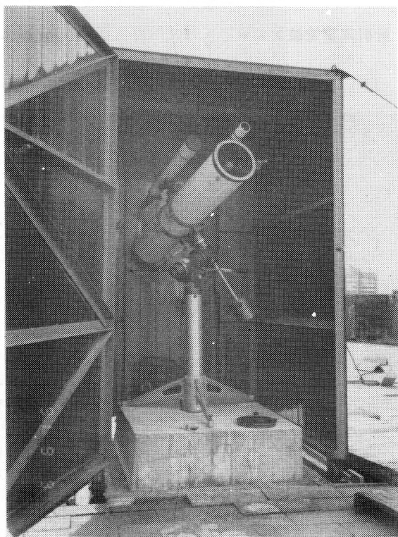
照片七 反射式望遠鏡，口徑 153 mm。
