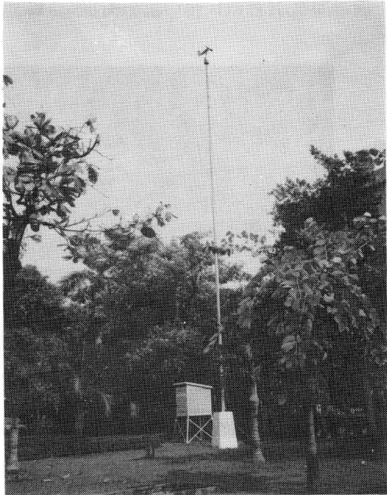
照片八 氣象觀測百葉箱及 風向風速計之外觀
