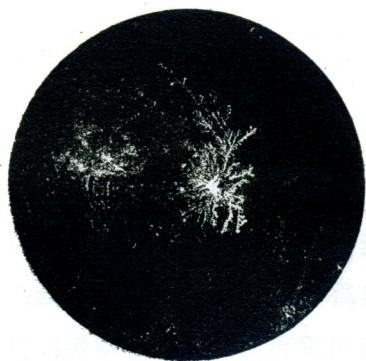
〔照片五〕 在濾紙上由電解所形成的銀樹
