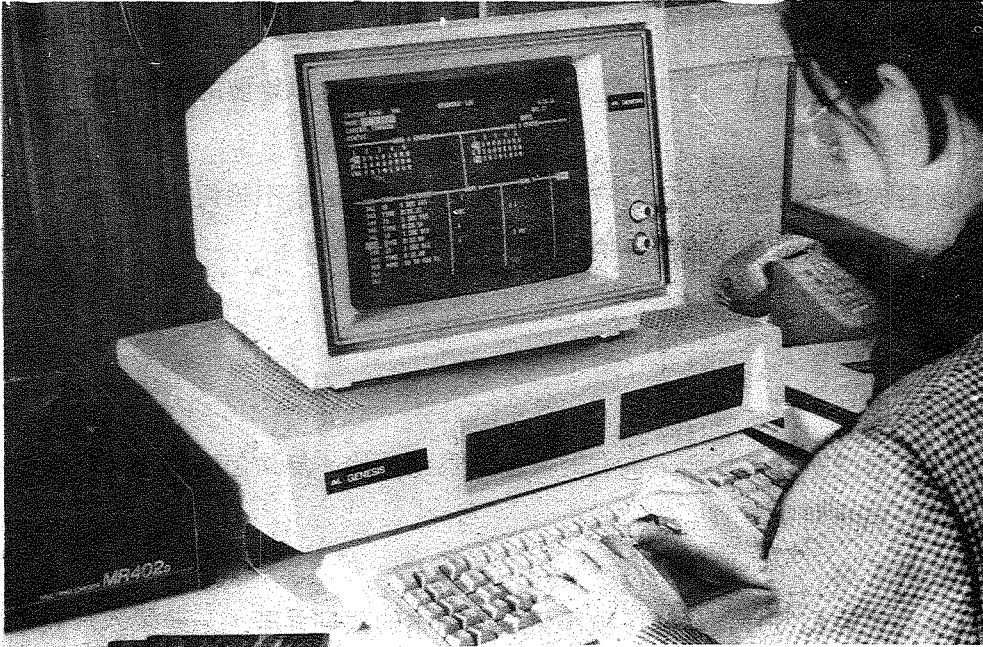
圖七 將放映設備與電腦連線後，進行編序與同步輸入，使得節目於放映時只要啟動開關，即可全部自動化演出。
