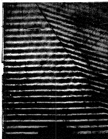
圖 14-19(a) 直線波的折射 （斜向入射介質的交界面） 注意在折射的同時，仍有微弱的反射波。
