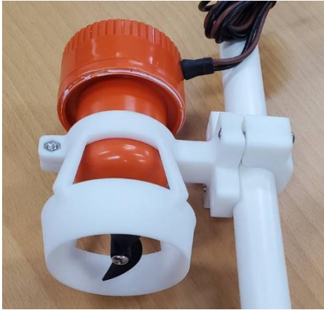
圖四使用 3D 列印製馬達架以及螺旋槳套環。
