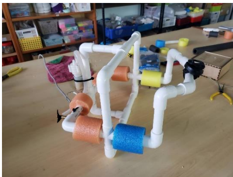
圖一在機身加裝抽水馬達與視訊鏡頭，浮力的部分以浮條來提供。
