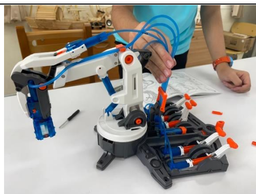
測試膠針筒、膠管與關節之連結
