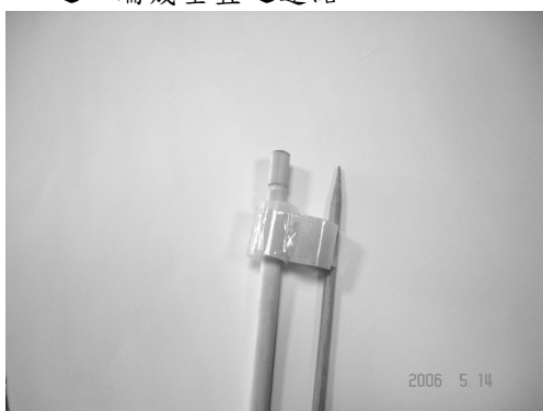
C、一小段吸管及一段較粗之吸管與竹籤平行連接，並將該段粗吸管套入竹籤支架突出部分
