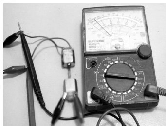
圖二、通電後，馬達快速振動，電表指針動了
