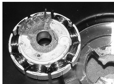
圖四、硬碟馬達無電刷
