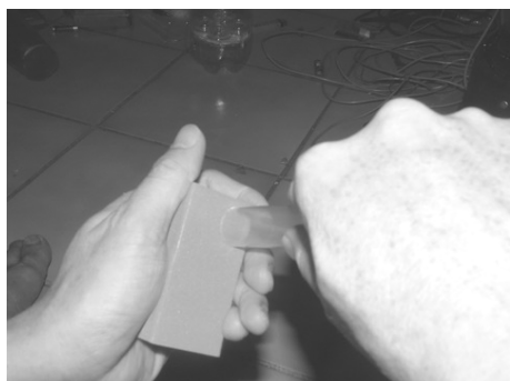
圖十二、用透明管在海綿上旋轉，即可將海綿穿透
