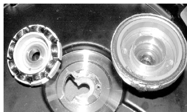
圖三、分解硬碟馬達，有線圈、磁鐵
